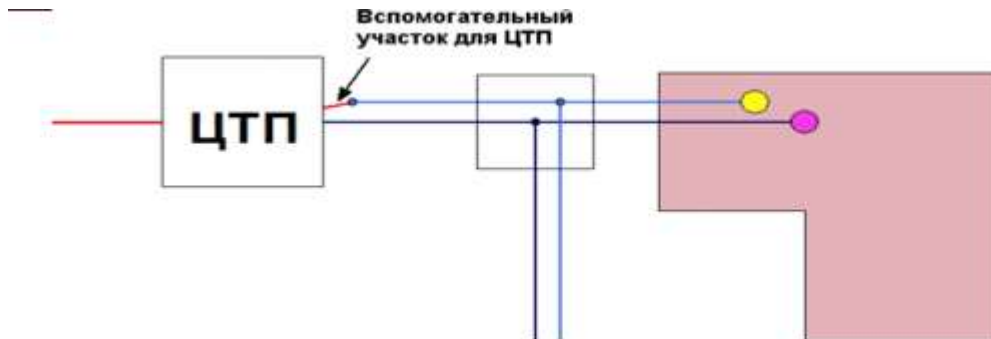
Рисунок 3.5 – Подключение трубопровода ГВС
